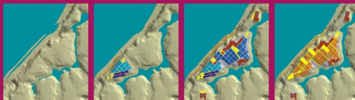
O sítio original de Salvador da Bahia, a primeira e a segunda fases de construção da cidade, as diferentes malhas ortogonais, a adaptação ao sítio, as praças que pontuam a malha urbana e a lógica global do traçado
